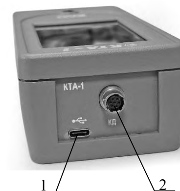
1 – разъём для подключения внешнего зарядного устройства; 2 – разъём кондуктометрического датчика
